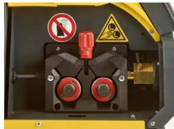
Mecanismo de alimentación profesional de doble ranura con 4 rodillos
