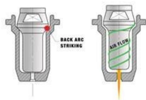
Tecnología "Back Striking" para cebado de arco, al no utilizar Alta Frecuencia no daña componentes electrónicos.
